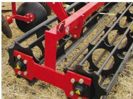
Высокоэффективный сдвоенный каток
