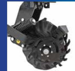
Приспособление для удаления сорняков и шаг регулировки заглубления 11–6 мм.
