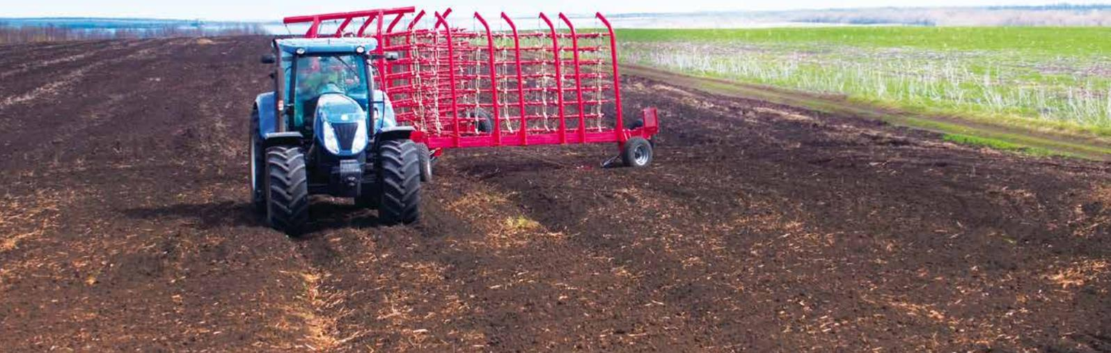
Специальная конструкция рамы и прицепного устройства позволяет одному трактористу переводить борону из транспортного положения в рабочее и наоборот. А для возможности быстрого раскладывания/складывания ЛАРИ имеет ходовые колеса с изменяемым углом схождения.
