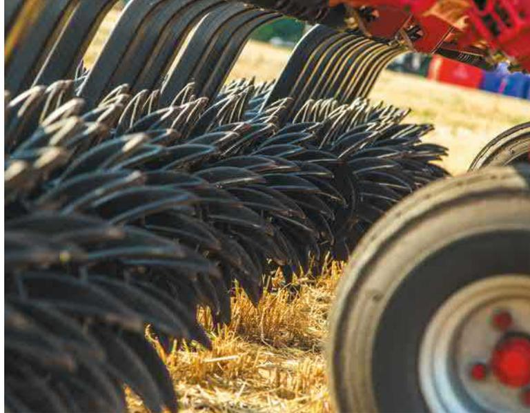
Ротационные бороны ДИНАР, как интенсивно работающие агрегаты, могут наилучшим образом выполнять подготовительные работы по обработке почвы и подходят как для традиционной, так и для консервирующей обработки. Они предназначены для сплошной и междурядной обработки различных зерновых и пропашных культур, а также овощей на всех типах почв. При этом особенно эффективно эти бороны применяются для разрушения тяжелой почвенной корки, ведь ДИНАР интенсивно перемешивает и крошит почву на глубину до 5 см.
