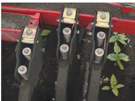
**Двухступенчатая регулировка давления на почву**
